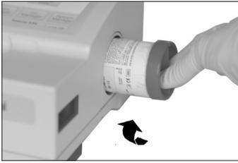
Abb. 7-24 Gasflasche installieren
