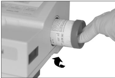
Abb. 2-8 Gasflasche installieren
