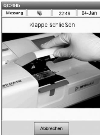
Abb. 2-20 Klappe schließen
