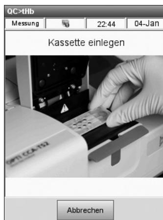
Abb. 2-19 Kassette einsetzen
