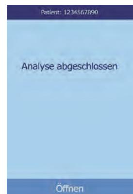
8. **Öffnen** drücken, um das Fach zu öffnen und die Reagenzdisk zu entnehmen.
