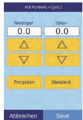
**Hinweis:** Wird für beide Werte Null eingegeben, wird der Ausdruck der Bereiche für dieses Analyt unterdrückt (stattdessen erscheinen Leerstellen). Ebenso wird die Überprüfung des gemessenen Werts anhand der Bereichsgrenzwerte unterdrückt.
