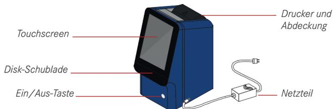
**Hinweis:** Im Lieferumfang sind folgende Teile enthalten: *Piccolo xpress™* Analysegerät, Netzteil, USB Kabel, Abaxis Treiber CD, mehrsprachige Bedienungsanleitung auf CD, Garantiekarte und Zubehör-Kit.
