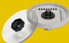
Winkelrotor 4 x 8-fach PCR Strips
