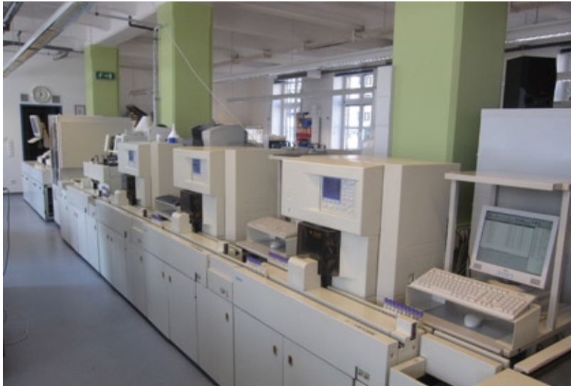
Abb. 2 Die Hämatologiestraße (von rechts). An drei XE-2100 schließen sich der Ausstrichautomat, der Probensortierer und die Blutsenkungsgeräte an.
