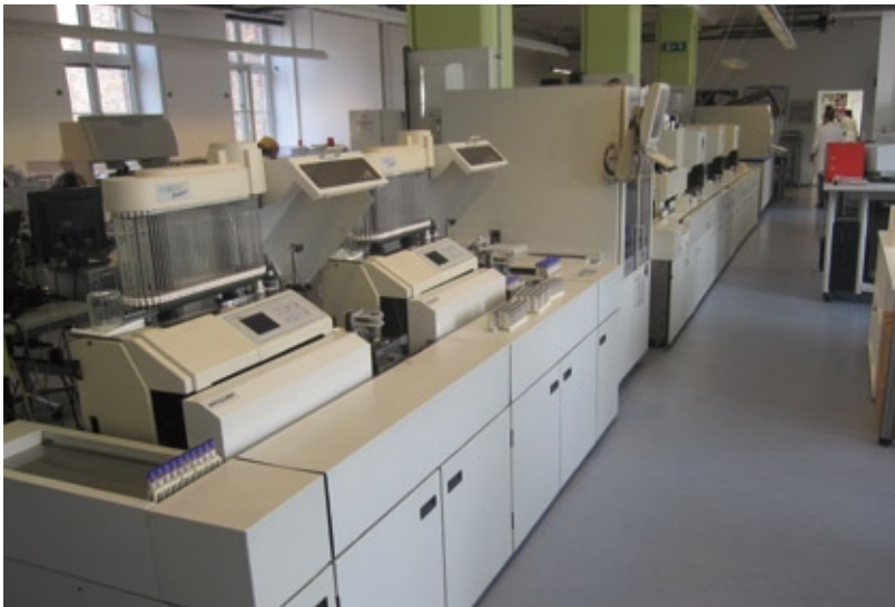
Abb. 3 Die Hämatologiestraße (von links). An zwei Blutsenkungsgeräte schließen sich der Probensortierer und drei XE-2100 an.
