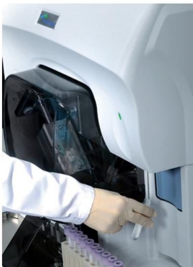
**Abb. 2** Messung von Körperflüssigkeiten am XT-4000i mit integriertem Body-Fluid-Modus
