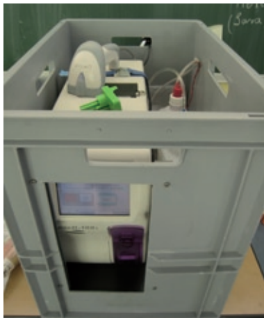
Abb. 3 POCH-100i in der Euronorm-Box mit maßgeschneiderter Auspolsterung und eingebauten Stoßdämpfern
