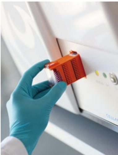
Das Gerät wird mit den mit Barcodes markierten Objektträgern beladen. Das System bewegt die Objektträger automatisch unter die Mikroskoplinsen, fügt Immersionsöl hinzu, lokalisiert die Zellen, nimmt eine Vorklassifizierung vor und zeigt die hochaufgelösten Bilder sortiert dem Benutzer, so dass dieser das Differenzialblutbild schnell validieren kann.
