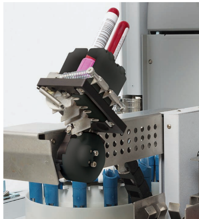
Automatisiertes Mischen der Patientenprobe
