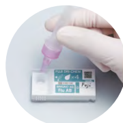
Eingabe der Probenflüssigkeit in den Probenkanal der Kartusche
